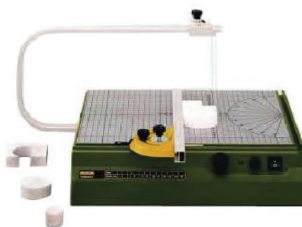
图6-29 电热丝切割机
