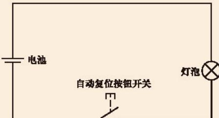
图5-59 动合自动复位电路
