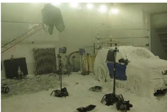
图7-2 汽车环境风洞降雪模拟试验
