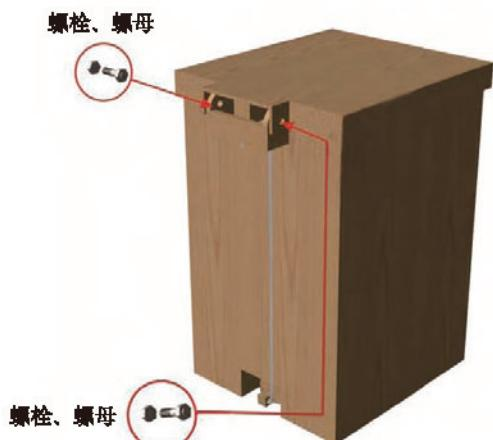
图6-51 螺栓、螺母装配示意图
