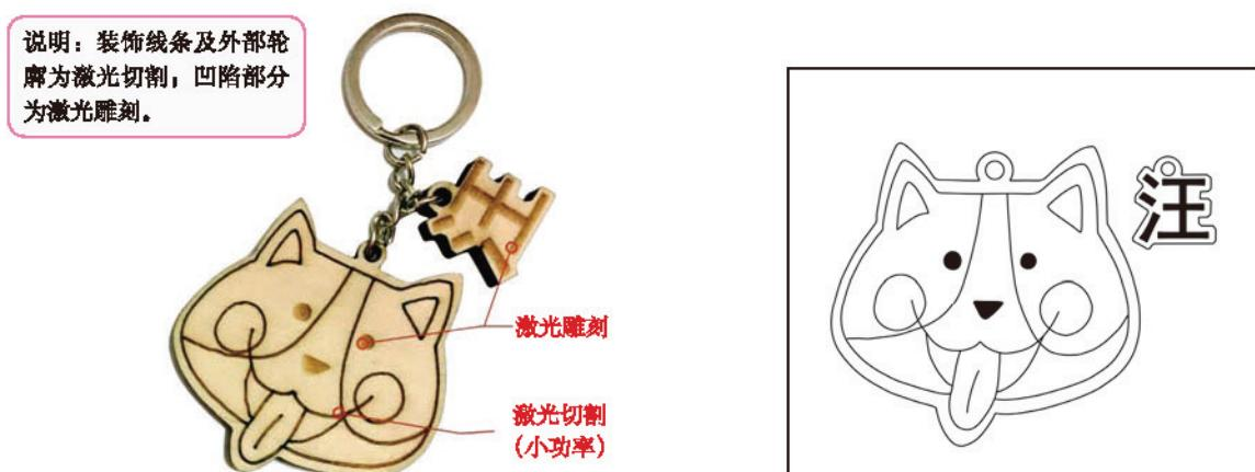
图6-34 用激光雕刻切割机加工的钥匙链挂饰
