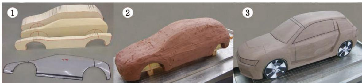
图6-9 较大油泥模型的制作方式
