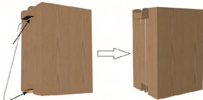
图6-50 顶杆装配示意图
