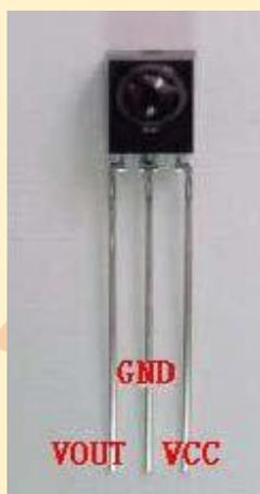
用的时候将 VOUT 接到数字口，GND 接到实验板上的 GND,VCC 接到实验板上的+5v。
