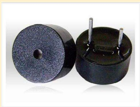
蜂鸣器按其驱动方式的不同,可分为:有源蜂鸣器(内含驱动线路)和无源蜂鸣器(外部驱动) 教你区分有源蜂鸣器和无源蜂鸣器,现在市场上出售的一种小型蜂鸣器因其体积小(直径只有 11mm)、重量轻、价格低、结构牢靠,而广泛地应用在各种需要发声的电器设备、电子制作和单片机等电路中。有源蜂鸣器和无源蜂鸣器的外观如图 a、b 所示。a)有源 b) 无源。
