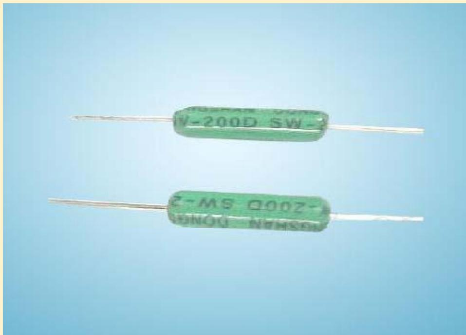
滚珠开关：也叫碰珠开关、摇珠开关、钢珠开关、倾斜开关，倒顺开关、角度传感器。它主要是利用滚珠在开关内随不同倾斜角度的变化，达到触发电路的目的。目前滚珠开关在市场上使用的常用型号有 SW-200D、SW-460、SW-300DA 等，本节使用的是 SW-200D 型号的。这类开关功效同水银开关，但没有水银开关的环保及安全等问题。
