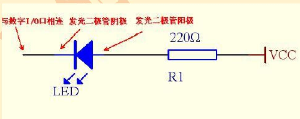
在这个电路中，数字 3 引脚为高电平 5V 时 led 灯熄灭，然后延时 1s，数字 3 引脚为低电平 0V led 灯点亮，再延时 1s。这样使 led 灯亮 1s、灭 1s，在视觉上就形成闪烁状态。如果想让 led 快速闪烁，可以将延时时间设置的小一些，如果想让 led 慢一点闪烁，可以将
