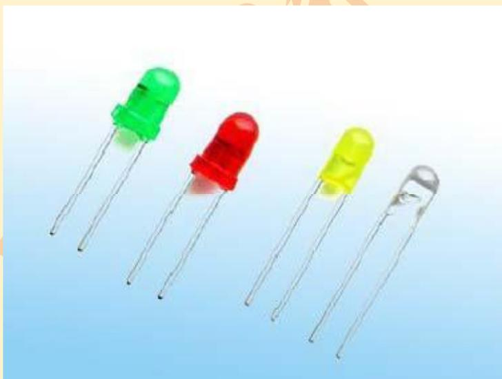
它是半导体二极管的一种，可以把电能转化成光能；常简称为 LED。发光二极管与普通二极管一样是由一个 PN 结组成，也具有单向导电性。当给发光二极管加上正向电压后，从 P 区注入到 N 区的空穴和由 N 区注入到 P 区的电子，在 PN 结附近数微米内分别与 N 区的电子和 P 区的空穴复合，产生自发辐射的荧光。不同的半导体材料中电子和空穴所处的
