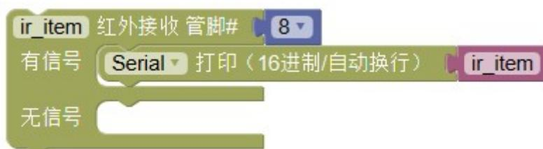
上传到 Arduino 中。上传完成后，**打开串口监视器**。按下遥控器上的按钮就能看到对应的控制代码。
