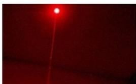
有一种激光防御装置：光源发射一道激光照射在光线传感器上。如果激光被入侵者遮挡，就会报警。我们尝试搭建一个报警器模型：有光时蜂鸣器不响，没光时报警。
