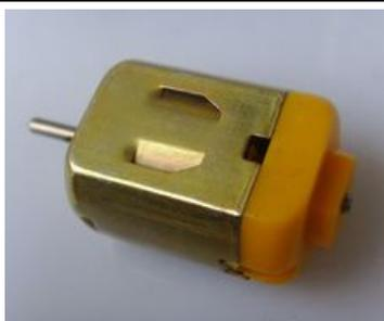
直流电机（direct current machine）是指能将直流电能转换成机械能的旋转电机因电流较大，用 Arduino 控制需借助晶体管或继电器做执行器来间接控制。风扇模块已经集成了这些元件，可直接连在数字口上用模拟输出（前面的鬼火控制亮度的方式）调速。
