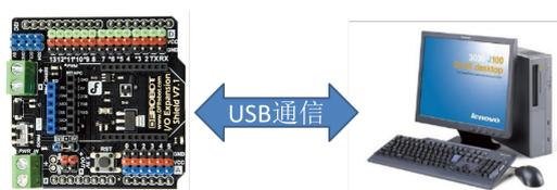
写入程序，打开最右侧的按钮“串口监视器”，可以看到读数。Serial 打印的意思是：将数据发送到电脑上显示。
